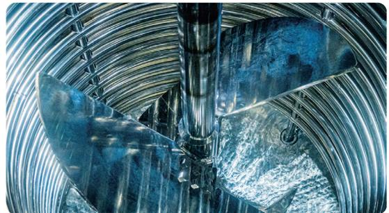
ラジカル重合等の爆発的反応が起こり、激しい発熱が生じる重合プロセスにおいて、その反応を安全に制御するための内部コイルを備えた設備を保有しています。これを用いることにより従来は溶剤によって希釈して行わなければならなかったラジカル重合反応をより高濃度で行うことができ、高分子量化、工程短縮することができます。また、冷却・加熱の切り替えにより効率よく系内を設定温度にすることが可能です。
